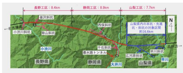
図 1. 山梨県内において発生するトンネル湧水をポンプアップする区間
