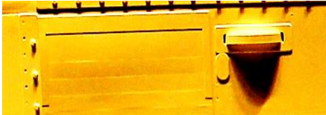
右に飛び出している円盤がおそらく「ストッパ一車輪」。左側のシャッターが降りたような感じになっている部分から低速走行の時に「補助輪」(案内輪)が出てくるのだと思います。
