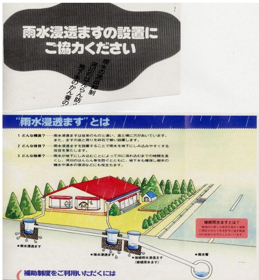
図3 雨水浸透枡パンフ（横浜市パンフより）
